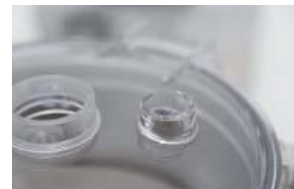
Couvercle transparent avec orifice pour ajouter des liquides
